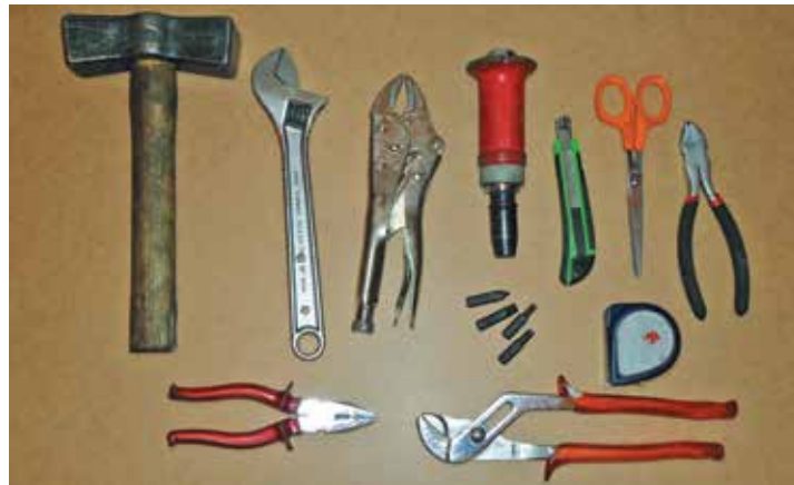
Imprescindibles a bordo: maza o maceta, llave inglesa (para sujetar más que para apretar), mordaza, botador (un cincel de cabeza plana), cuchilla, tijeras, corta-alambres, alicate, tenazas, cinta métrica, puntas de destornillador...
