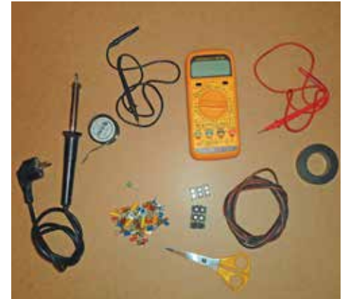
Para averías eléctricas. Soldador de estaño, multímetro, terminales, clemas, retales de cable y cinta aislante nos sacarán de muchos apuros. Para usar el soldador a bordo, necesitarás un transformador o un equipo adaptado a la tensión de la red del vehículo.
