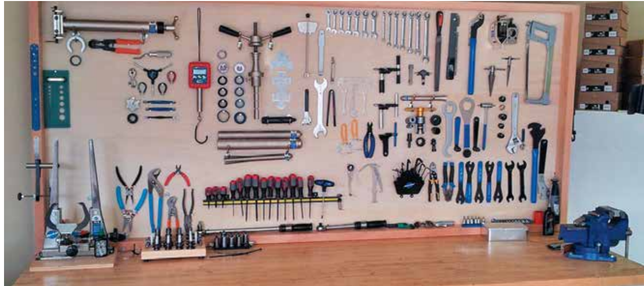
¿Cuál es la herramienta más grande que aparece en la imagen? El banco de trabajo. Un banco sólido, despejado, bien iluminado y provisto de un tornillo bien anclado es lo primero que necesitaremos para trabajar de forma adecuada.
