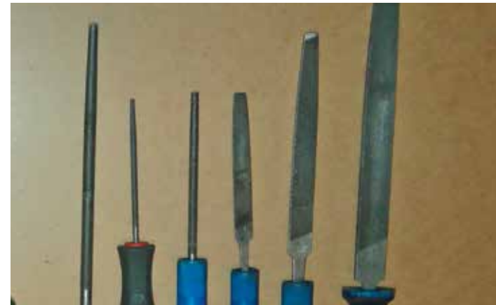
Un juego de limas, escofinas y limatones es muy interesante por si tenemos que rematar algún "recorte" de emergencia. Hay diferentes grados de abrasión y sus hojas pueden ser curvas, planas, cilíndricas, trapezoidales...
